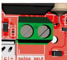
Esta salida se utiliza para activar un relé auxiliar, donde el tiempo de activación está definido por la configuración del **RELÉ**.
