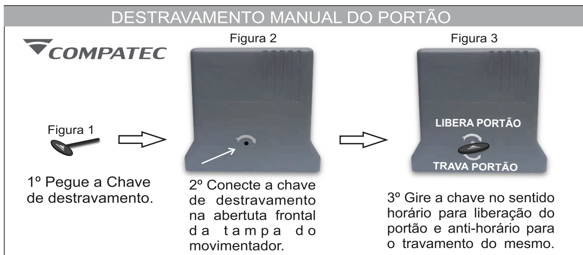
Figura 8: Destravamento manual do portão.
