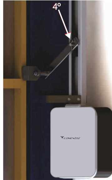
**Figura 6:** 1º Fixar com um pingo de solda o “Cavelete com Pino” no “Braço de Destravarmento” o “Suporte Dobrado”. 2º Posicionar o “Braço de Destravarmento” sobre o pino do “Fechamento da corrente”. 3º Com o portão todo fechado, fixar com pingo de solda o “Cavelete com Pino” na parte móvel do portão. 4º colocar o “Espelho do Braço” sobre o “Braço de Destravarmento” e colocar o pino de “Travamento do espelho do Braço”.
