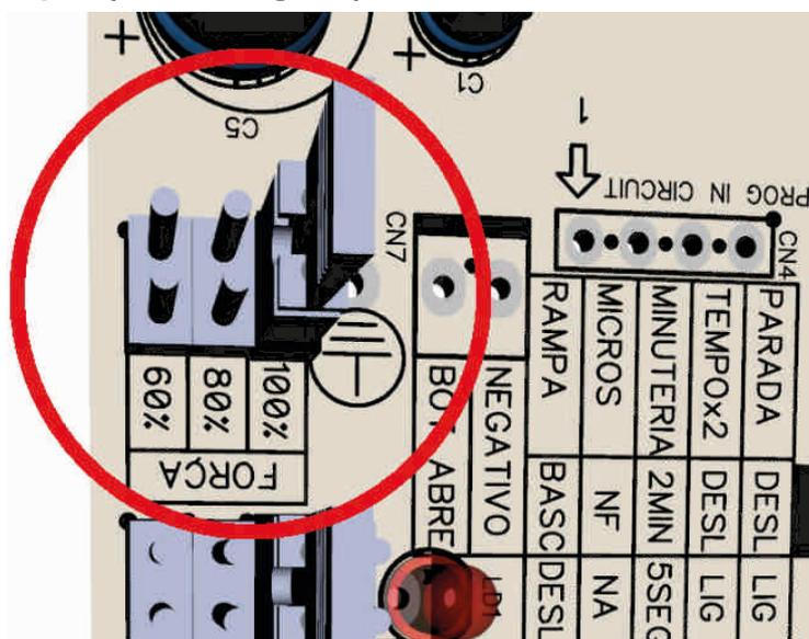
Afim de evitar o esmagamento, além da fotocélula é possível controlar a quantidade de energia fornecida para o motor através do jumper força, em 100%
