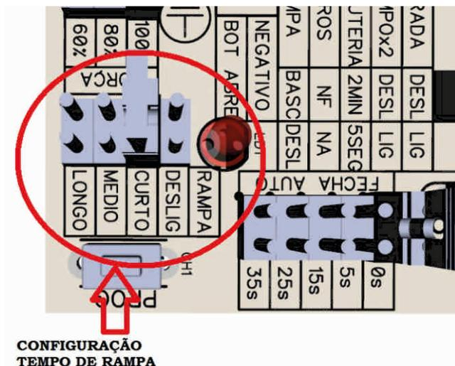
A distância de início de acionamento da rampa é programada automaticamente junto ao tempo de percurso. Essa distância poderá ser alterada pelo jumper Cn9 de RAMPA, podendo ser configurado um tempo CURTO, MEDIO, LONGO ou DESLIGADO. Uma segunda configuração da RAMPA é o Cn11, nas configurações gerais por jumper, onde o jumper RAMPA serve para configurar se o portão é leve ou pesado.
